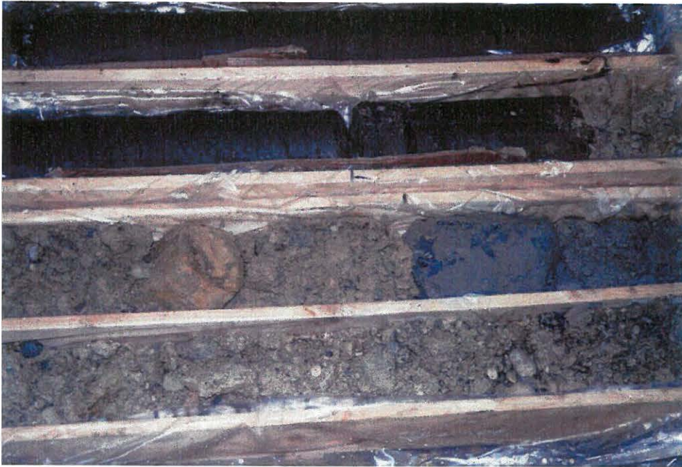
Abb. 16: Mittel- bis Grobkiessedimente der Niederterrasse mit Übergang zum Schlier Baulos Umfahrung Enns, ÖK 51
