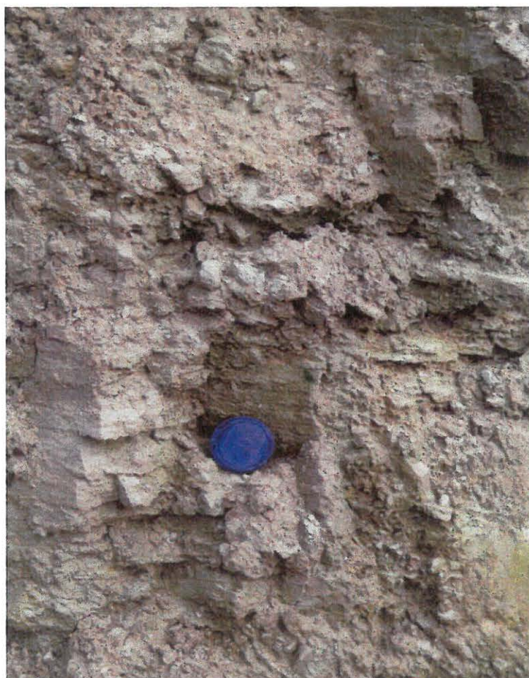
Abb. 45: Dunkelbraune bis graue, siltige, sandige Tonmergel (Rieder Schichten) (ÖK 47)
