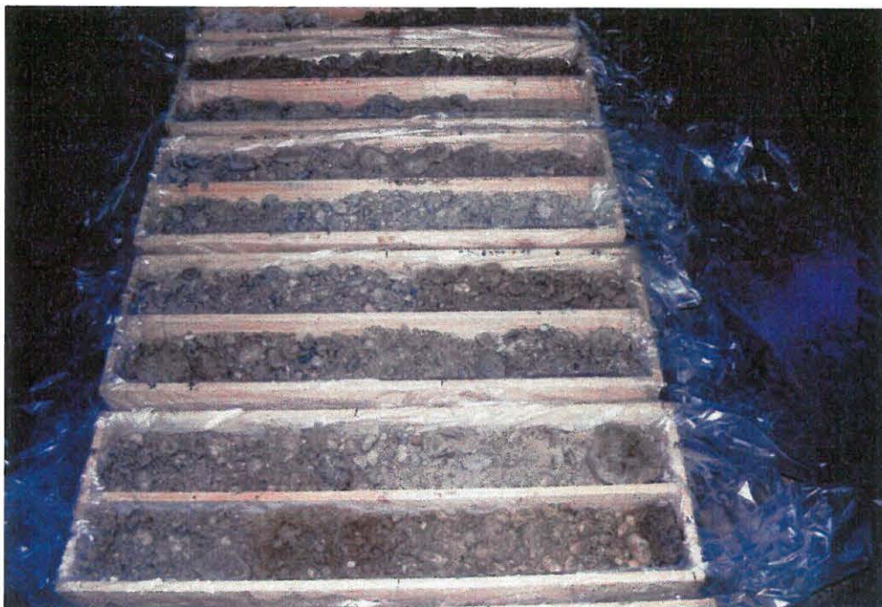
Abb. 17: Mittel- bis Grobkiessedimente der Niederterrasse Baulos Umfahrung Enns, ÖK 51
