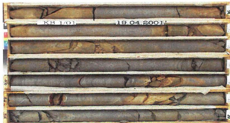
Abb. 52: Kernbohrung innerhalb der Rhenodanubischen Flyschzone – Baulos Micheldorf (ÖK 68)
