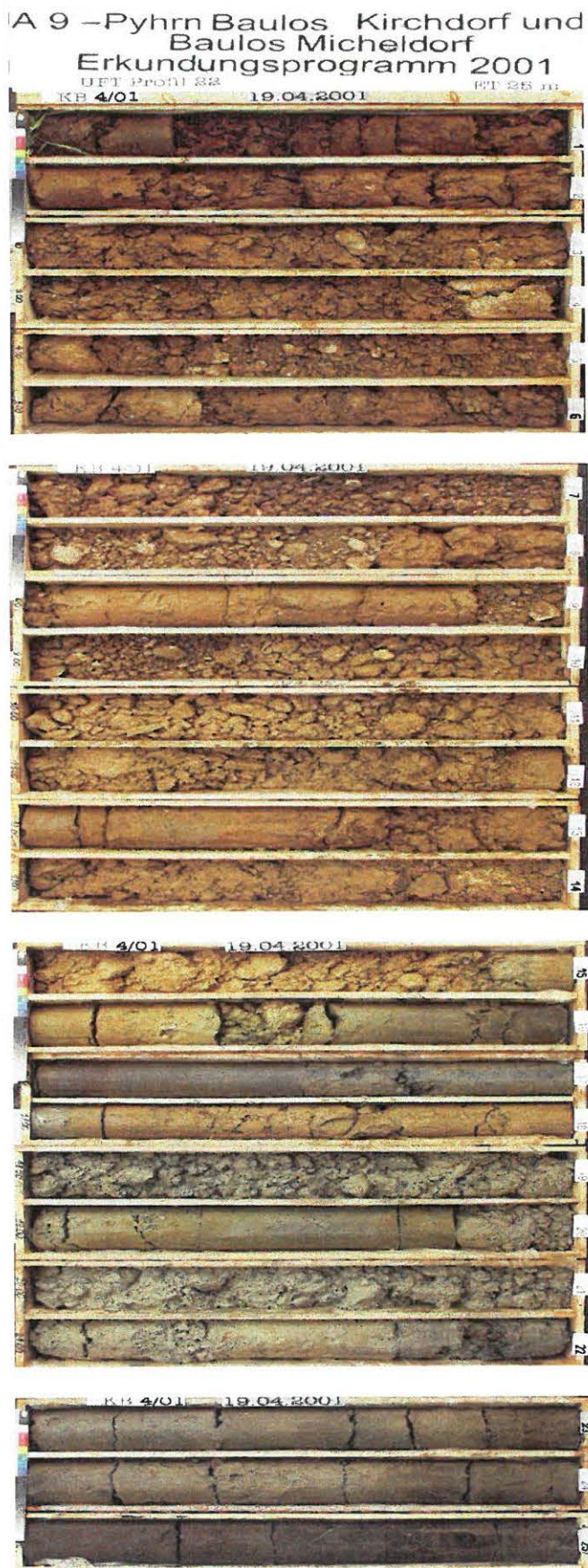
Abb. 53: Kernbohrung in schluffigen, kiesigen Sedimenten, Baulos Micheldorf (ÖK 68)
