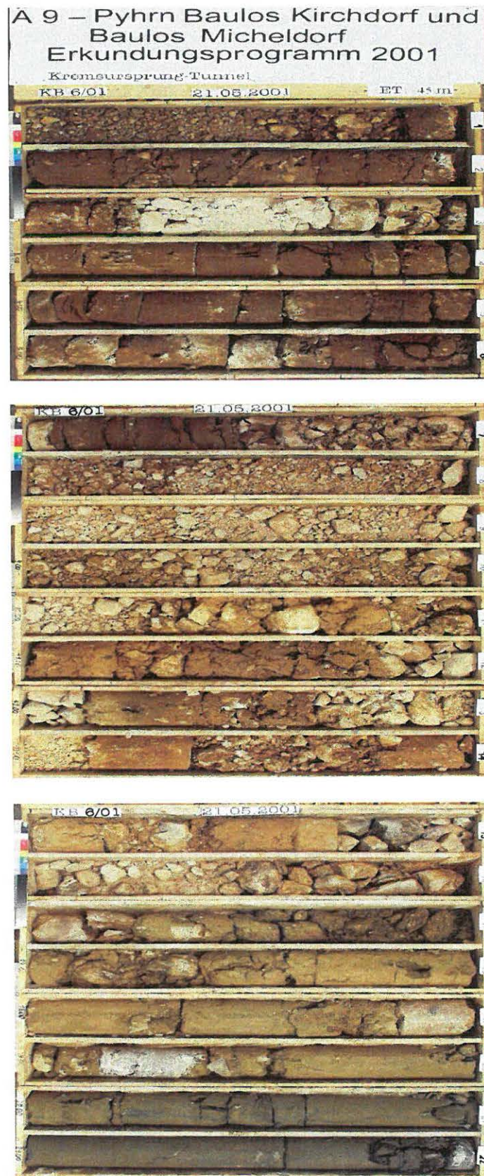
Abb. 58: Kernbohrung innerhalb der Nördlichen Kalkalpen, Baulos Micheldorf (ÖK 68)
