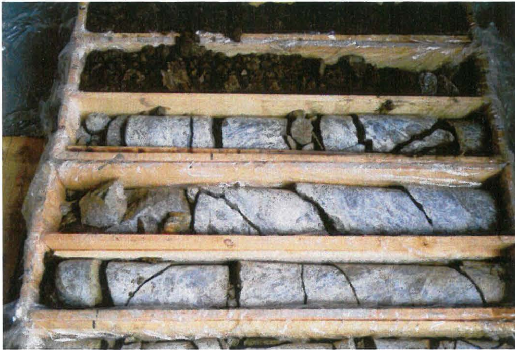
Abb. 4: Quartäre Deckschichten auf Cordieritperlgneis Baulos Wels – Passau, Abschnitt Wernstein – Passau (ÖK 12)
