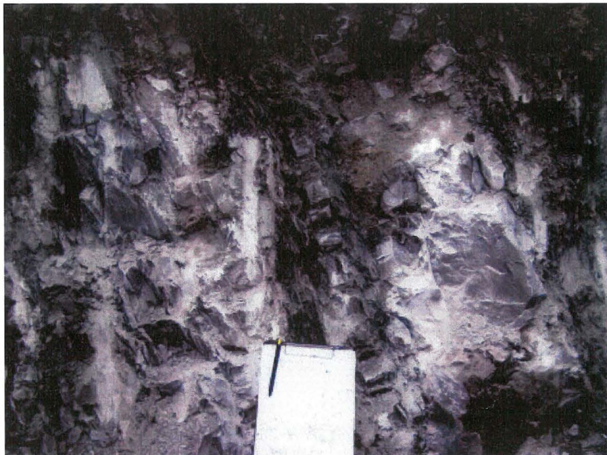
Abb. 49: Feinkörniger Sandstein/Tonschiefer-Wechselfolge, grau, stark mylonitisiert (ÖK 68)
