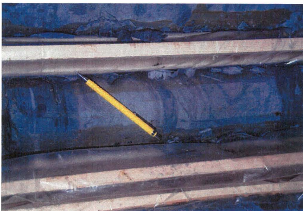
Abb. 19: Einschaltungen von Feinsandsteinlinsen in Älterem Schlier Baulos Umfahrung Enns (ÖK 51)
